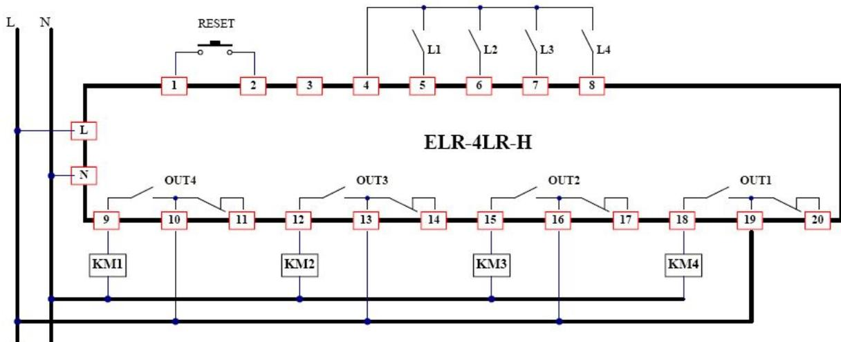
注：图中 L1~L4 分别为 4 路计时的启动控制开关，REST 为外接复位按钮，L、N 为工作电源，OUT1~OUT4 分别为 4 路输出继电器的触点，KM1~KM4 为外接接触器线圈。
