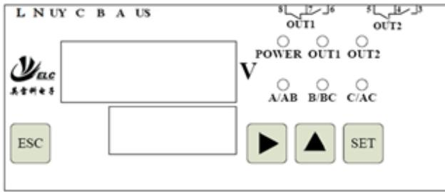
大窗口显示被测电压，小窗口显示电压整定值。POWER-电源指示灯，OUT1-OUT2 继电器动作指示灯，A、B、C 指示当前显示电压来源。
